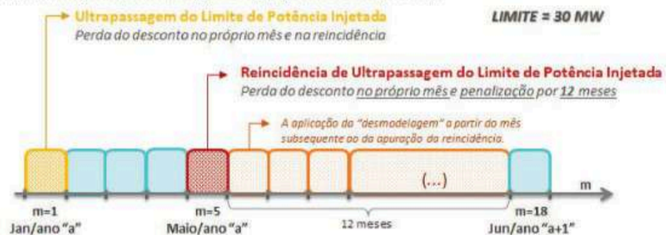
Figura 26 - Alterações do tipo de energia da usina em função da ultrapassagem de 30 MW
