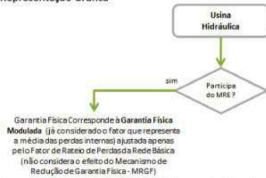
Figura 14: Fluxograma de definição da garantia física de usinas hidráulicas que participam do MRE
